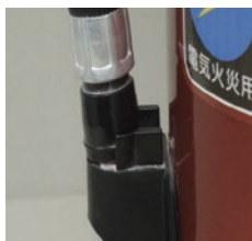
× 消火薬剤の漏れ
